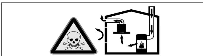
Raumluftabhängige Feuerstätten (z.B. gas-, öl-, holz- oder kohlebetriebene Heizgeräte, Durchlauferhitzer, Warmwasserbereiter) beziehen Verbrennungsluft aus dem Aufstellraum und führen die Abgase durch eine Abgasanlage (z.B. Kamin) ins Freie. In Verbindung mit einer eingeschalteten Dunstabzugshaube wird der Küche und den benachbarten Räumen Raumluft entzogen - ohne ausreichende Zuluft entsteht ein Unterdruck. Giftige Gase aus dem Kamin oder Abzugsschacht werden in die Wohnräume zurückgesaugt.
